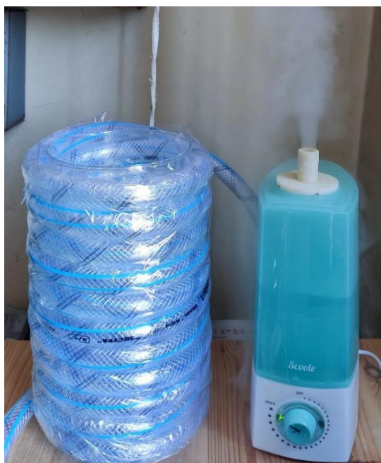
Рис. 2. Фото «контрольной» «паровой катушки» и работающего парогенератора
