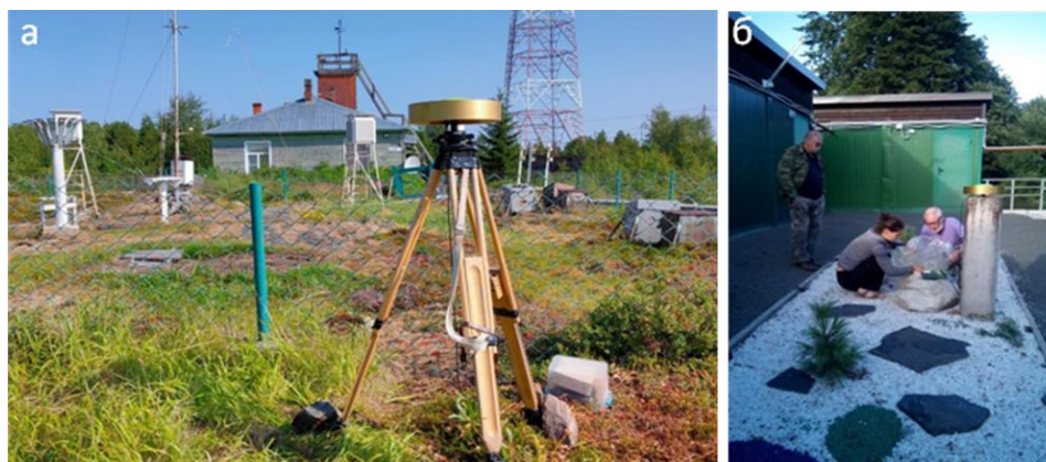
Рис. 3 а) пункт ГНСС КЕМР; б) установка оборудования на пункте BOTS
